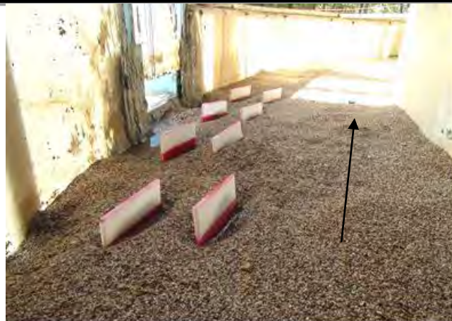
شکل (۴): آبخستگی ایجاد شده دور صفحات مستغرق در جلوی دهانه آبگیر
